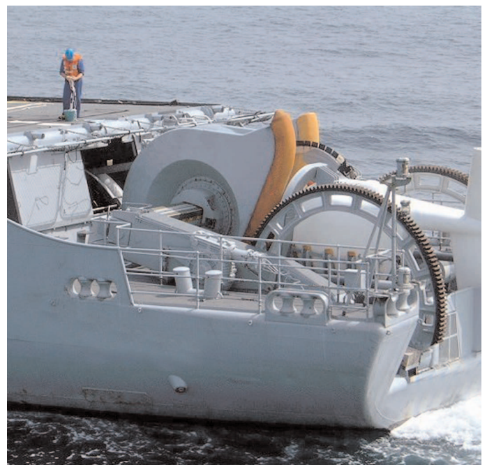
Fregatte des Typs F70 mit variablen Tiefensonar
